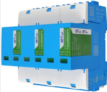
光伏系统电涌保护器Surge Protection Device For PV System ( SPD ), 用于太阳能发电防雷保护的一种装置, 对感应雷和直击雷影响或其他瞬时过压的电涌进行保护, 适用于光伏发电、风能发电及其他工业领域直流电涌保护的要求。当电气回路或者通信线路中因为外界的干扰突然产生尖峰电流或者电压时, 电涌保护器 ( SPD ) 能在极短的时间内导通分流, 从而避电(浪)涌对回路中其他设备的损害。
